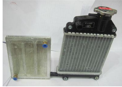
Bộ trao đổi nhiệt kênh mini (bên trái) có kích thước nhỏ hơn so với kết nước trên xe gắn máy tay ga (bên phải)
