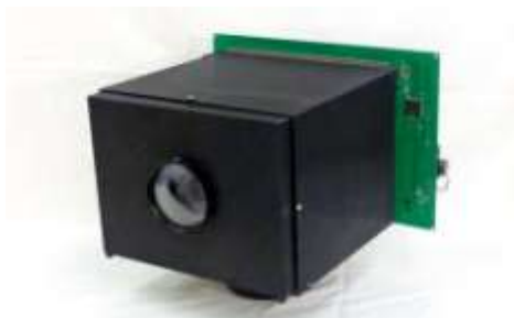
Máy quay tự cung cấp năng lượng. Ảnh: Computer Vision Laboratory
