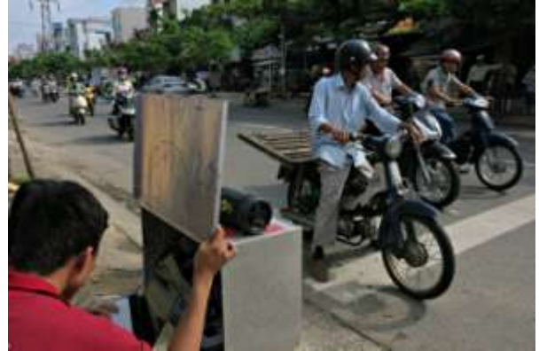
Hệ thống tự động phát âm thanh cảnh báo khi người tham đi đường dừng xe sai vạch.
