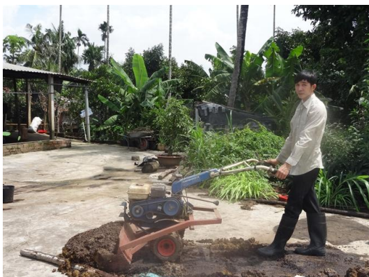
Máy ủ phân của Lập được cải tiến từ máy cày tay
