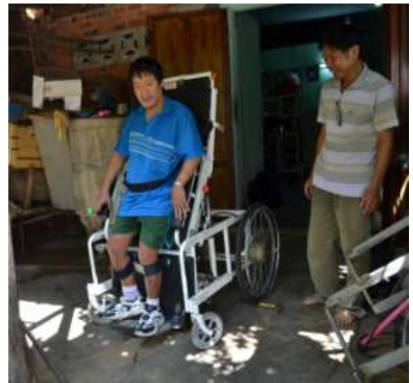
Ông Thắng và chiếc “xe lăn điện dạng đứng” - Ảnh: Duy Thanh
