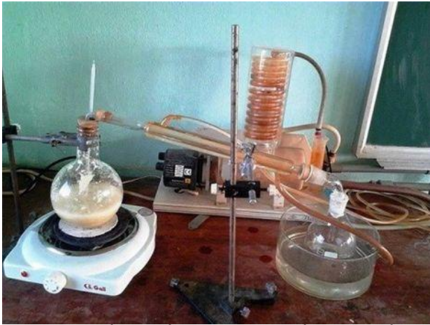
Bộ chung cất lôi cuốn hơi nước tinh dầu tỏi. (Nguồn: quangngai.gov.vn)
