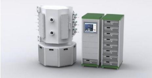
Mô hình thiết bị mạ chân không theo phương pháp hồ quang
