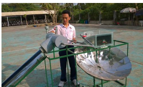
Thiết bị biến nước mặn thành ngọt. Ảnh do nhóm nghiên cứu cung cấp.
