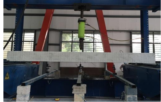
Tiến hành thí nghiệm uốn dầm để kiểm tra khả năng chịu lực của dầm bê tông cốt thép. Ảnh: Nhân vật cung cấp.
