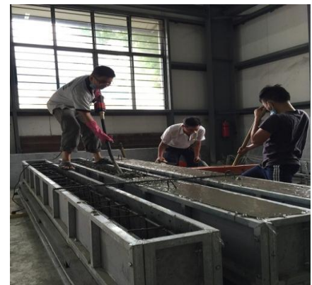
Tiến hành đổ bê tông lên mẫu dầm và các mẫu trụ. Ảnh: Nhân vật cung cấp.
