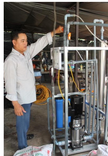
Máy lọc nước mặn thành nước ngọt tự chế của anh Quang có công suất 400 lít mỗi giờ. Ảnh: A.X
