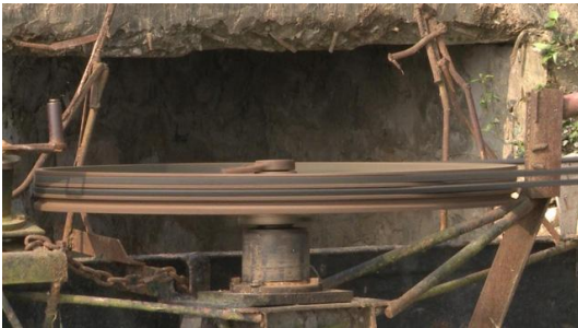
Hệ thống truyền lực làm bơm hoạt động với công suất lớn 4000m 3 /h
